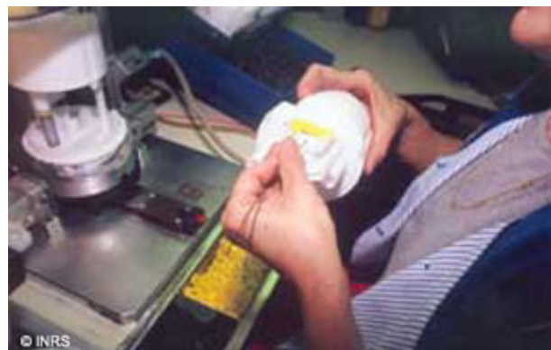
Poste d'assemblage de pièces pour l'automobile : prise en pince
